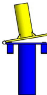
4120 Le jeu de 4 platines de basculement avec charnières. Facilite la pose et la dépose des poteaux.
