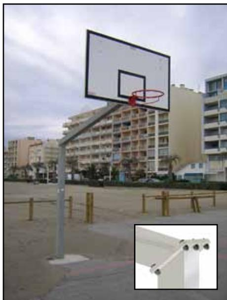
**4296G** But de Basket Ball déport 2,25m. Structure en acier de section 120x120mm Finition galvanisée. Panneau de basket-ball en polyester 1,80x1,05m cercle renforcé hauteur 3,05m et filet. Scellement direct au sol dans socle en béton. L'unité.
