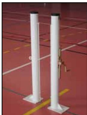
**4802** Poteaux de tennis en acier galvanisé sur platine. Finition thermolaquée coloris blanc. Tube de Ø 90 mm. Tension du filet par treuil à traction rectiligne. Fixation au sol par cheville chimique. La paire. (Le filet se commande séparément)
