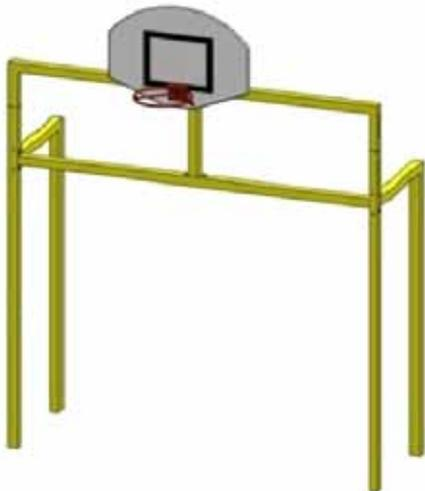
But de hand/foot/basket de dimensions 3x2m en acier galvanisé de section 80x80mm, finition thermolaquée coloris au choix. Panneau de basket-ball polyester demi-lune de 1,20x0,90m, fixé sur la structure (le panneau ne subit aucune force). Cercle renforcé à hauteur de 3,05m et filet de basket-ball.
